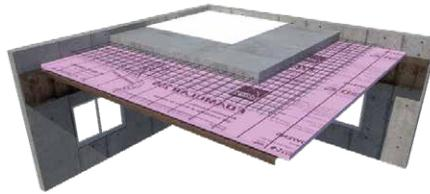
1- Losa. 2- Armado con varilla. 3- Foamular®. 4- Encofrado o simbra.
