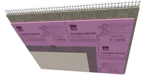
1- Empastado con malla de refuerzo acrílica. 2- Foamular®. 3- Losa de concreto.
