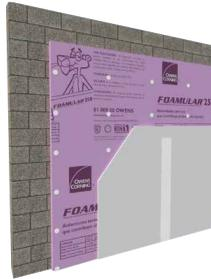
1- Tablero de yeso. 2- Foamular® con anclaje mecánico (clavos y arandelas). 3- Muro de block de concreto.
