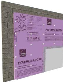
1- Empastado con malla de refuerzo acrílica. 2- Foamular® con anclaje mecánico (clavos y arandelas). 3- Muro de block de concreto.
