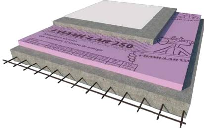
1- Impermeabilizante acrílico. 2- Capa de compresión (4cm min). 3- Malla hexagonal. 4- Foamular®. 5- Losa de concreto
