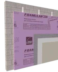
1- Pintura de acabado. 2- Empastado con refuerzo de malla acrílica. 3- Foamular®. 4- Muro de block.
